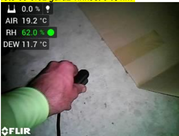
foto 11 +12 0.02 garáž vlhkost podlaha 0 % hm
