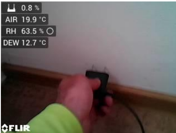
foto 21 +22 1.01 chodba 1 vlhkost 0,8 % hm
